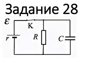
В электрической схеме (параллельно соединённые резистор и конденсатор через ключ подсоединены к источнику) ключ был длительное время замкнут, известны э.д.с. источника и отношение внутреннего сопротивления батареи к сопротивлению резистора. После размыкания ключа на резисторе выделяется заданное количество теплоты. Требовалось определить заряд конденсатора до размыкания ключа.
