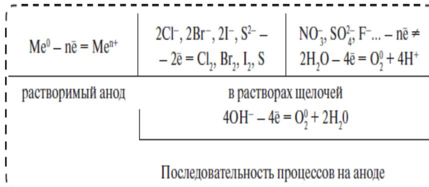
Схема 2. Последовательность процессов окисления на аноде
