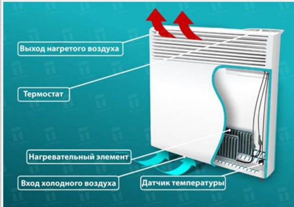
Принцип работы электрического конвектора достаточно прост. Конвектор – прибор, в котором теплопередача происходит за счёт естественного движения воздуха – конвекции: холодный воздух, вступая в контакт с электрическим нагревательным элементом, увеличивает собственную температуру, становится легче и выходит через фронтальную решётку, которая обеспечивает отличное распределение тепла по всему помещению. За счёт циркуляции воздух в пространстве комнаты очень быстро прогревается.
